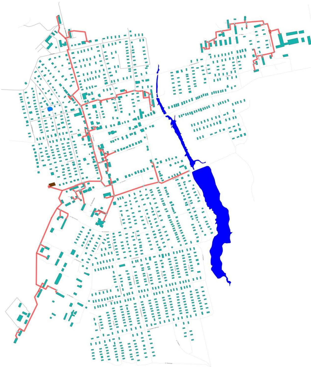
Рисунок 6. Схема тепловых сетей п. Палех
