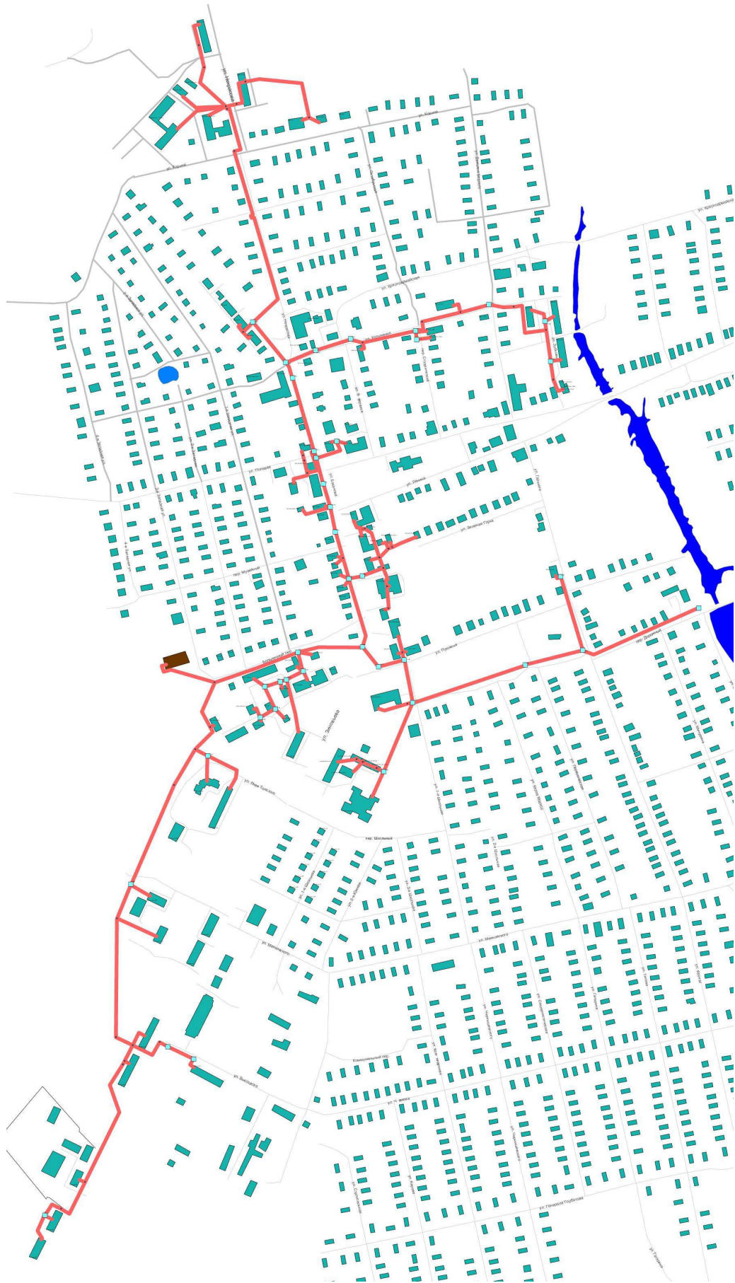
Рис. 3.1. Схема тепловых сетей от котельной ППОК.
